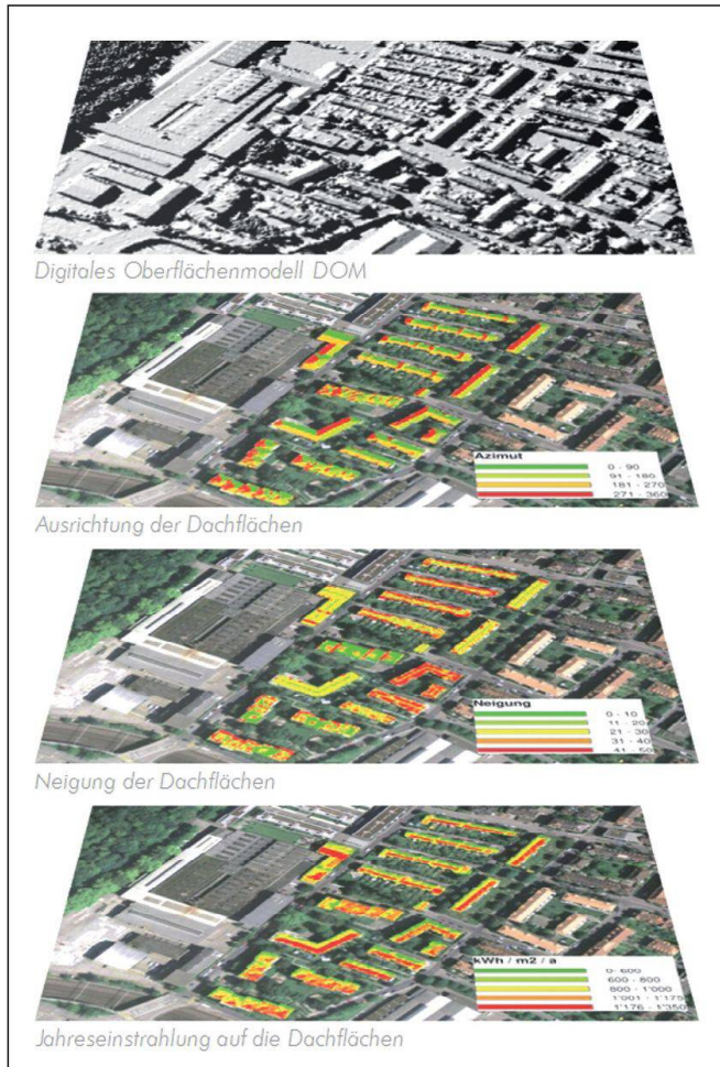
Ausschnitt eines Solarkatasters für die Umgebung des Meteotest-Gebäudes (oben in der Mitte).
