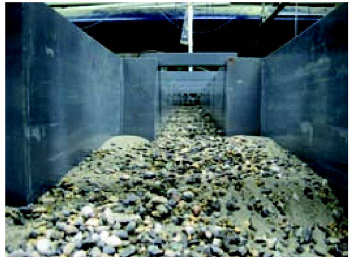
Fig. 2: Laboratoire LCH: Essai sur modèle physique en laboratoire simulant les conditions en l'absence du seuil: vue du chenal principal sur l'embouchure élargie de son affluent; suite à l'élargissement de l'embouchure, la morphologie du fond se diversifie, créant des conditions favorables à l'émergence de nouveaux habitats et à la libre circulation des poissons (LCH/EPFL).
