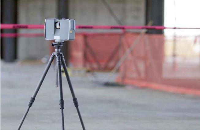
Abb. 2: Der Trimble TX5 Scanner gestattet mit kompakter und leichter Bauweise unvergleichliche Mobilität und Effizienz am Arbeitsort.
