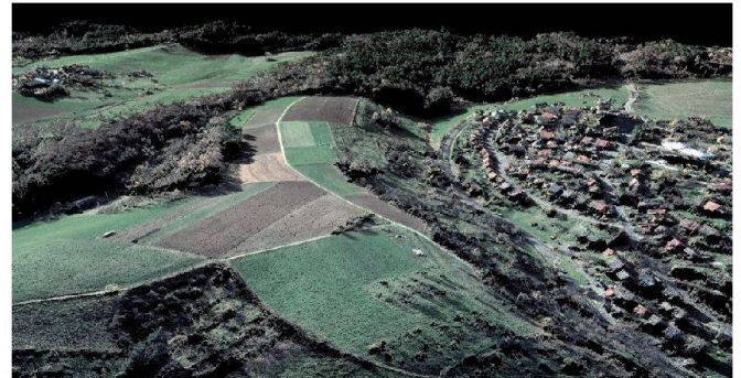
Abb. 10: In ImageStation 2013 generierte Punktwolke mit RGB-Kodierung.
