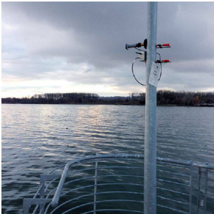
Fig. 2: Installation de la campagne d'acquisition du 22 novembre 2013. On remarque l'antenne, fixée avec son axe horizontal pointant vers le lac.
