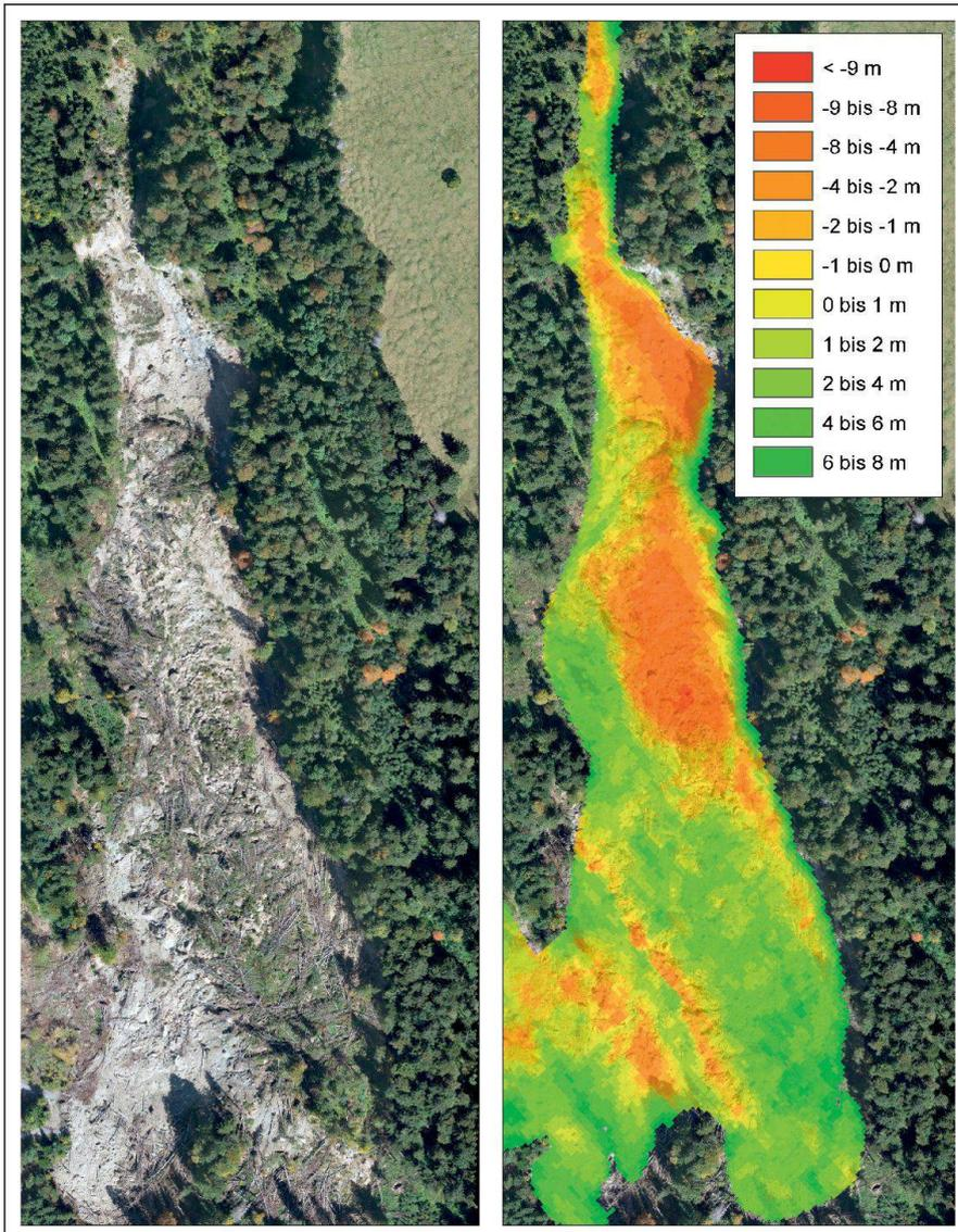
Abb. 5: Orthofoto und Differenzmodell DSM-UAV – DTM-AV.
