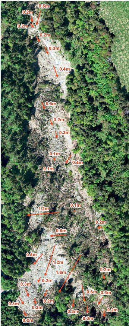
Abb. 8: Verschiebungsvektoren in der Hauptrutschmasse zwischen dem 11. Juni und 18. Oktober 2013; die initialen, deutlich grösseren Anfangsbewegungen sind hier nicht erfasst.
