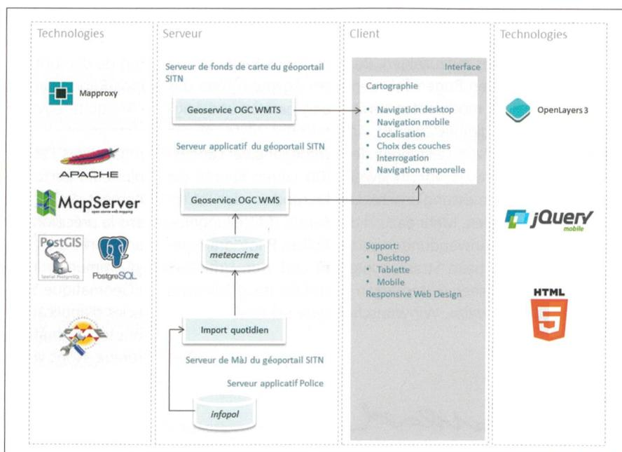
Fig. 1: Architecture de la solution et logiciels/librairies utilisées.
