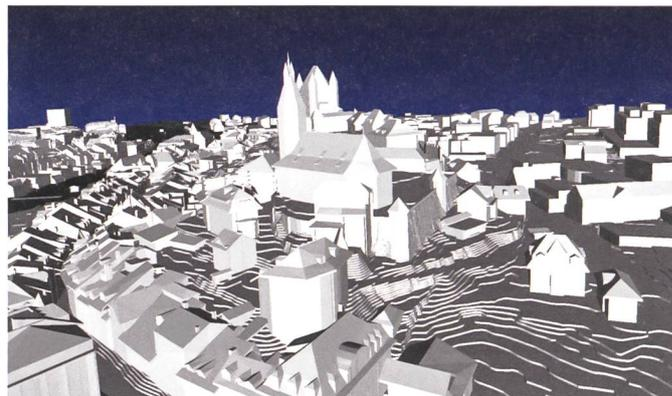
Abb. 3: Ausschnitt aus dem Stadtmodell Thun, vorwiegend aus photogrammetrischer Vermessung.
