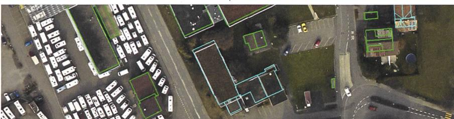
Fertig ausgewertete Dachflächen (dem Orthofoto überlagert).
