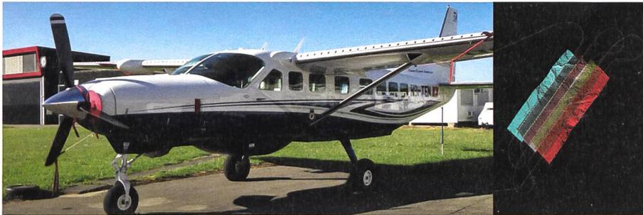
Flug mit Datenerfassung LiDAR und Luftbilder. Das Flugzeug von Swiss Flight Services hat zwei Öffnungen im Boden, damit können Laserscanner und hochauflösende Luftbildkamera parallel betrieben werden.
