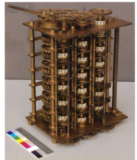
Abb. 4: Nachbau der Babbage-Differenzenmaschine von Roberto Guatelli. Charles Babbage (1792–1871) arbeitete ab 1822 an seiner ersten Differenzenmaschine, die jedoch unvollendet blieb. Sie sollte die fehlerfreie Erstellung mathematischer Tafelwerke ermöglichen. Die Maschine befindet sich in London (© Canada Science and Technology Museum, Ottawa, Objektnummer 2011.0022.001).
