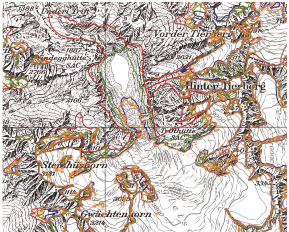
Abb. 7: Erste Version des Gletscherinventares aus dem Release 2018 des swissTLM 3D (orange) im Vergleich zu den Inventaren 1850 (rot), 1973 (grün) und 2010 (blau).
