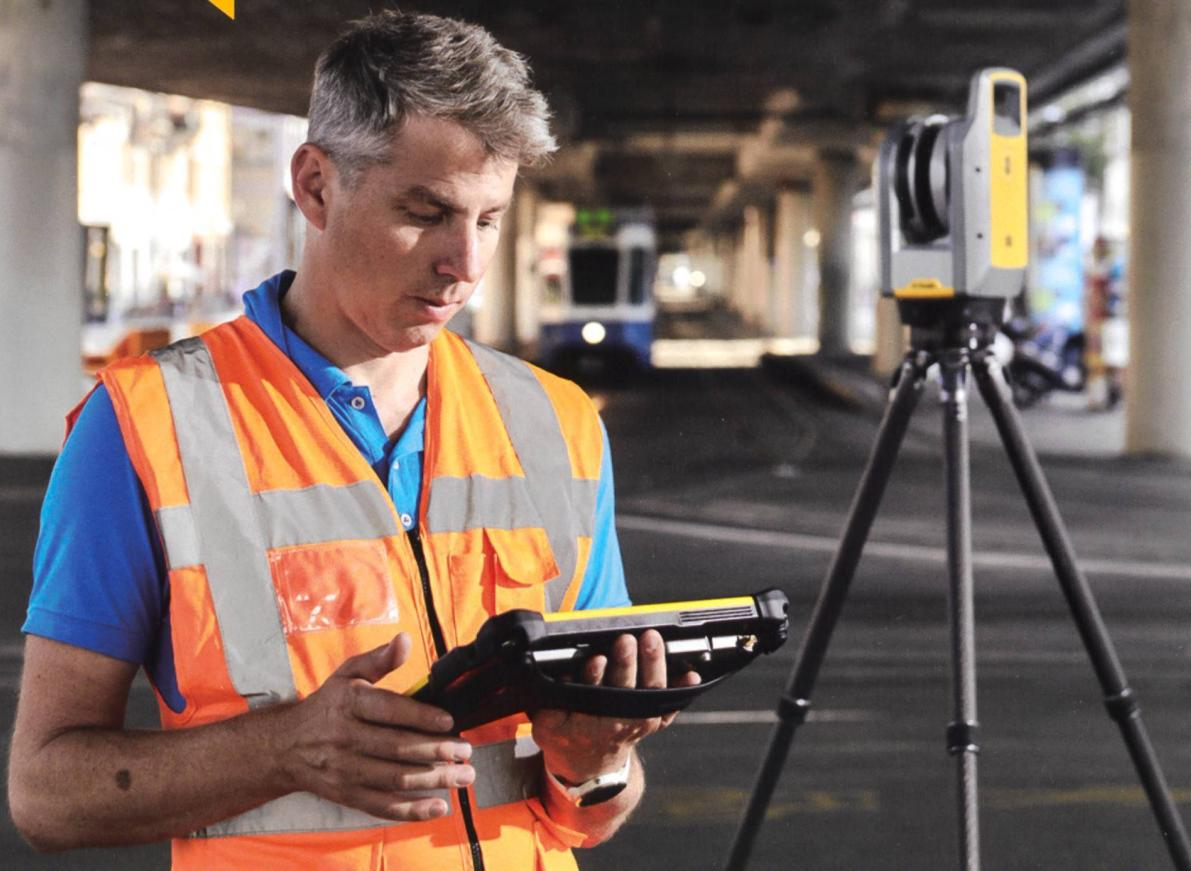
Der Trimble X7 ist das neue Hochleistungs-3D-Laserscanningsystem, mit vollautomatischer Registrierung, Selbstkalibrierung und -horizontalierung sowie aussergewöhnlicher Benutzer-freundlichkeit.
