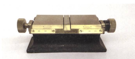
Abb. 4: Der Tastapparat, ein psychotechnisches Gerät zur Messung des räumlichen Feintastgefühls.
