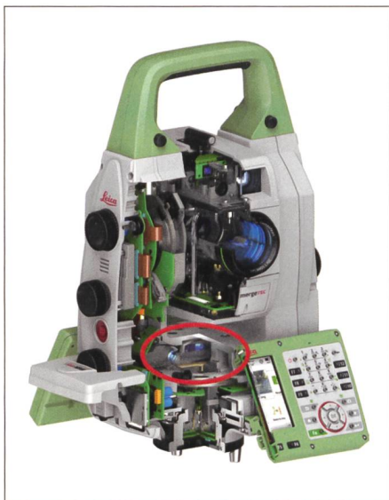
Abb. 7: Schnittmodell ScanStation mit Flüssigkeitskompensator.
