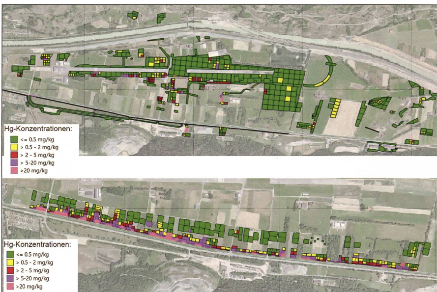
Abb. 8: Quecksilberbelastungen innerhalb des Perimeters der GM VBR und entlang des Grossgrundkanals (Stand Oktober 2020).
