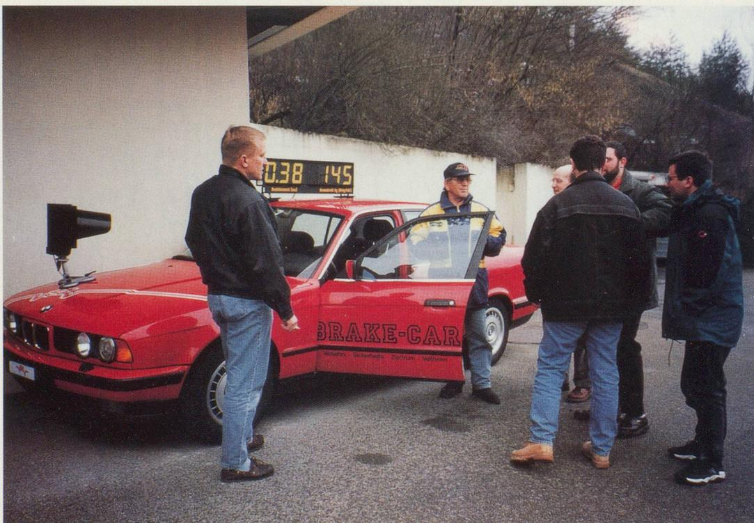
*Une voiture spéciale au centre ACS de Veltheim (AG) permet de tester les réflexes des conducteurs. Au signal, il faut enfoncer la pédale des freins le plus fort et le plus rapidement possible. Ici, l'élève a mis 38/100<sup>e</sup> de secondes pour une poussée de 145 kg.*
