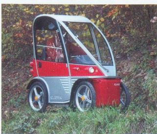
**Les véhicules Classic**, Le modèle de base à 3 roues a une autonomie de 40 à 65 km et sa vitesse peut atteindre 30 km/h. Toiture amovible en option. Temps de recharge: 8 h. Prix: dès Fr. 12 500.-.
