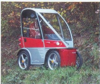
**Les véhicules Classic**, Le modèle de base à 3 roues a une autonomie de 40 à 65 km et sa vitesse peut atteindre 30 km/h. Toiture amovible en option. Temps de recharge: 8 h. Prix: dès Fr. 12 500.-.
