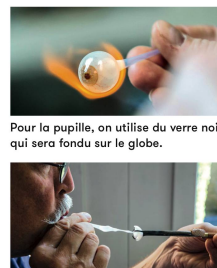
Les yeux de verre n'étant pas sphériques, l'artisan doit aspirer la partie postérieure.
