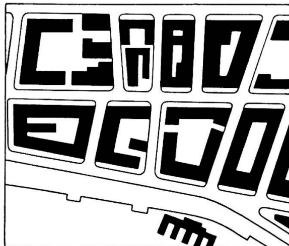
Abb. 17. Schachbrettähnliche Struktur mit einseitigem Durchgangsverkehr. 1 : 5000.
