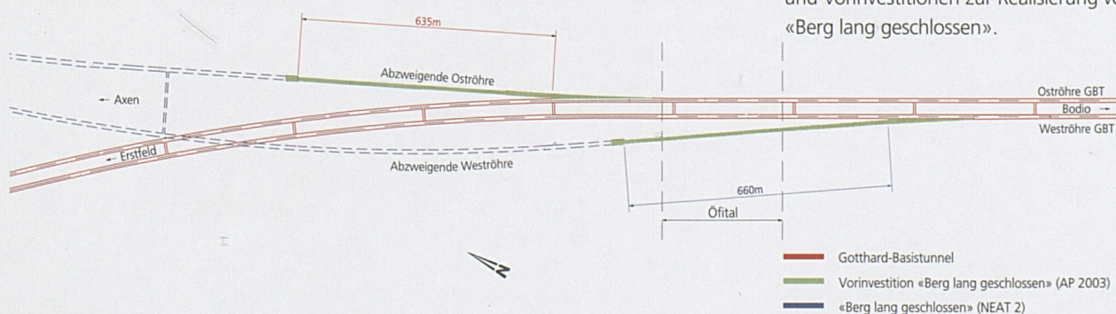
Verzweigungsbauwerk im Gotthard-Basistunnel zwischen Erstfeld und Amsteg
