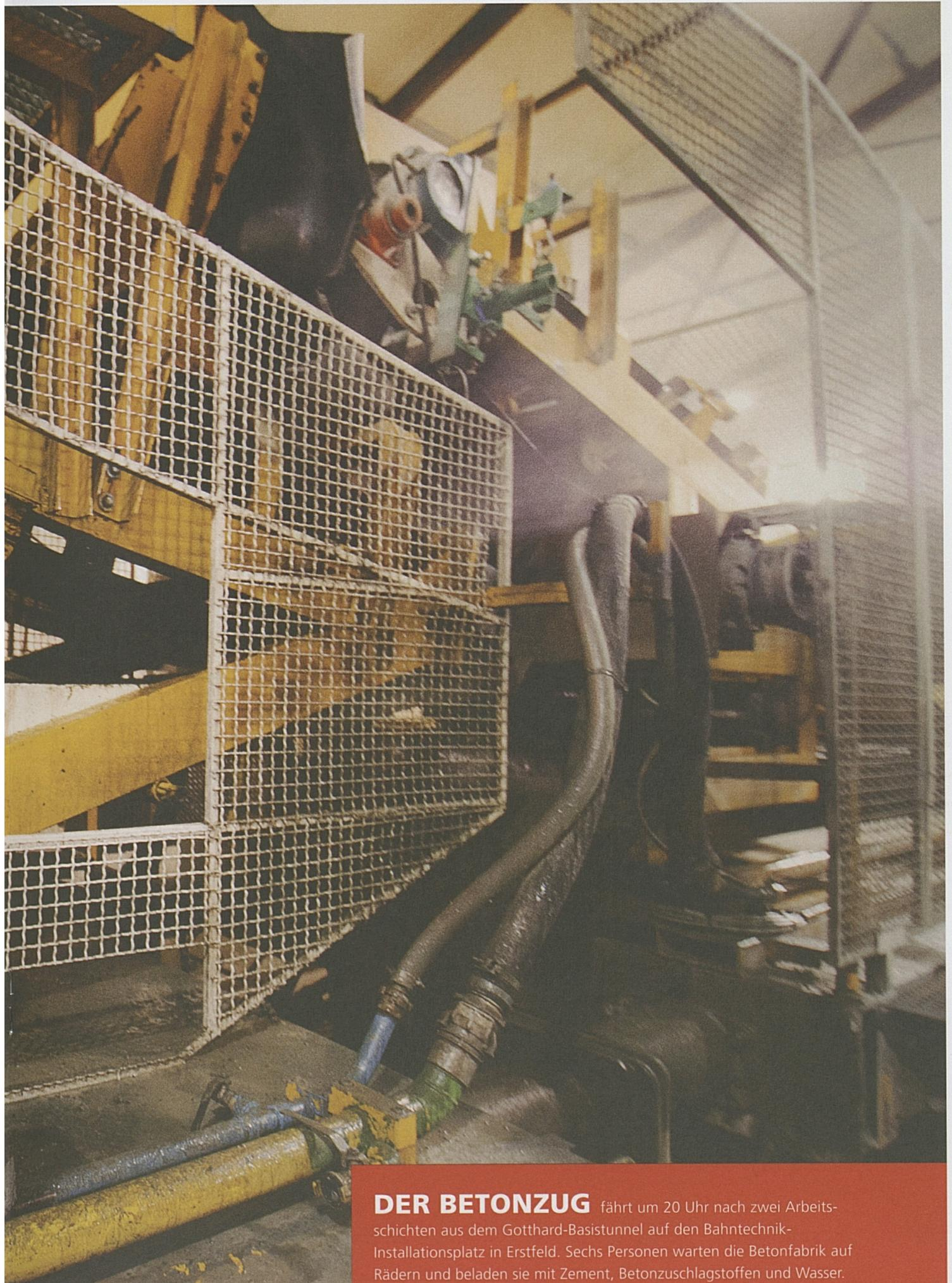
**DER BETONZUG** fährt um 20 Uhr nach zwei Arbeitsschichten aus dem Gotthard-Basistunnel auf den Bahntechnik-Installationsplatz in Erstfeld. Sechs Personen warten die Betonfabrik auf Rädern und beladen sie mit Zement, Betonzuschlagstoffen und Wasser. Pünktlich um 4 Uhr morgens steht der Zug für die nächste Schicht und den Einbau von weiteren 225 Metern Fester Fahrbahn bereit.
