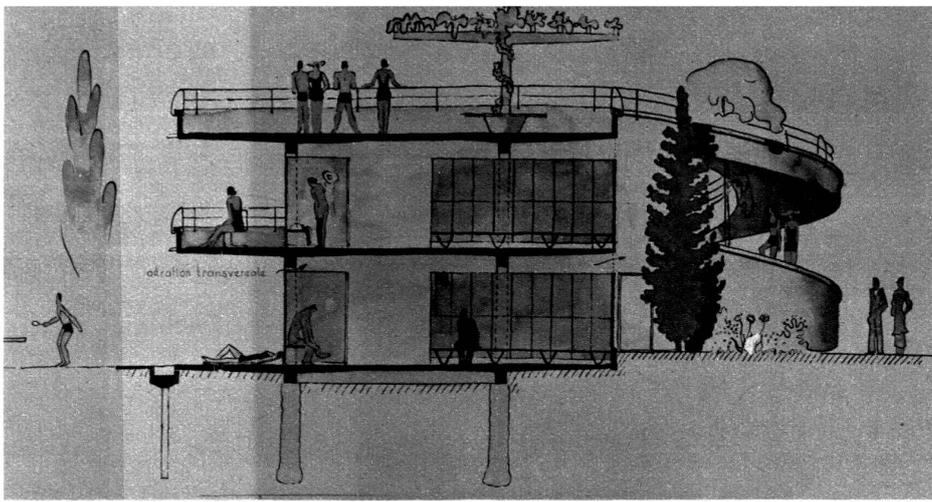
Coupe transversale du bâtiment des cabines. Construction en porte-à-faux exigeant un minimum de fondations et des sections de béton armé très fines.
