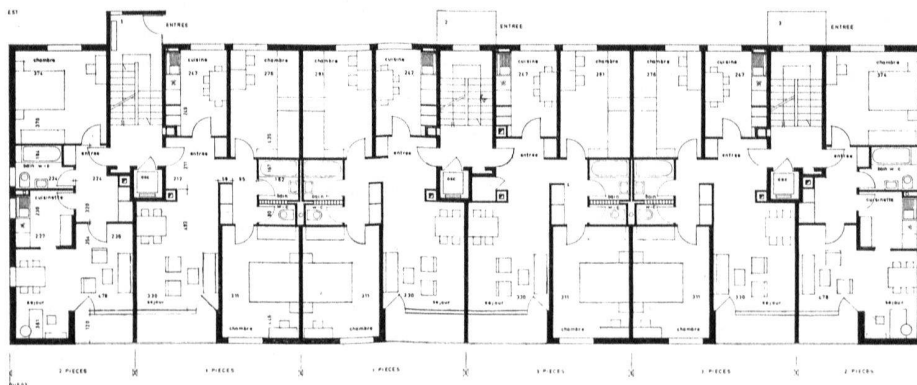
Immeuble A. Plan des étages, échelle 1 : 300
