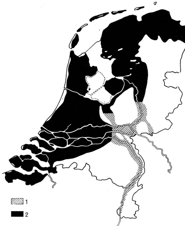
Fig. 2. Les Pays-Bas sans digues 1. Terres qui seraient inondées sans la présence des digues fluviales. 2. Terres qui seraient inondées sans la présence des digues.
