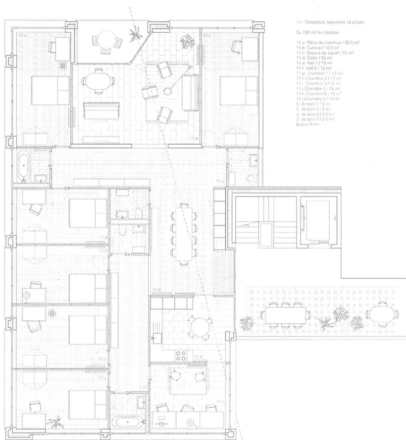
Projet des Saules. Plan d'un appartement contenant six chambres d'étudiant. Avec un salon et un balcon privatif, en haut, et une terrasse commune avec les deux appartements voisins, à droite. © Jaccaud Spicher Architectes Associés/DR
