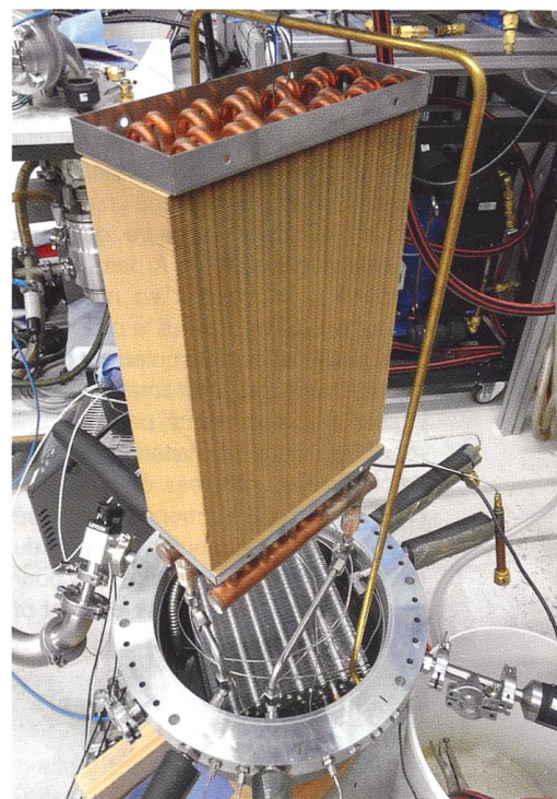
Echangeur de chaleur à adsorption testé à l'Institut for Solar Technologies de wla HSR de Rapperswil, en collaboration avec IBM Research Zurich. © SPF Rapperswil/IBM Research
