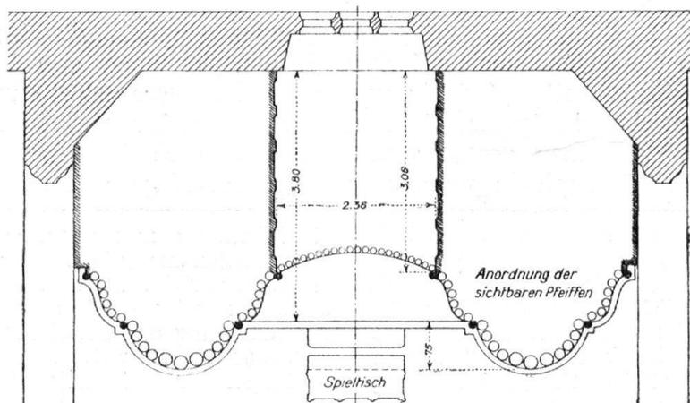
Abb. 14. Grundriss zum abgeänderten Entwurf „Friede!“ (1 : 200).
