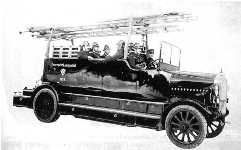
Von Schenk Worblaufen auf ein Berna-Chassis gebaute Motorspritze mit Mannschaftsabteil und Schiebeleiter, 1924
