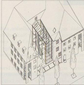
**Umbau des Alten Waisenhauses zu einem Institutsgebäude der Universität (1985–1988). Die Isometrie mit einem Schnitt durch die Rückfront zeigt das neue Treppenhaus aus Stahl und Glas anstelle der historischen Gasse. Auf dem linken Bild der hohe Luftraum zwischen den alten Fassaden und der Betonscheibe, unten die «Torsituation» am östlichen Stadteingang.**
