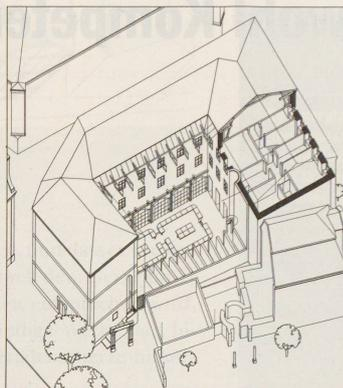
Isometrie mit Schnitt und Ansicht des «Ulmer Hofes» (1978–1980). Aus dem früheren Aussenraum wurde ein Innenraum der Universität mit Lesesaal und Bibliothek. Die historische Fassade (im Bild rechts) ist durch eine Stahlkonstruktion gesichert.
