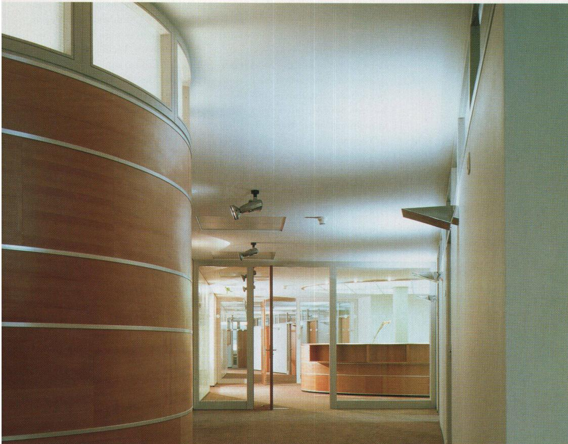
Die Decke in den Büros ist nur minimal abgehängt, die in den Erschliessungszonen der Lüftungsleitungen wegen etwas mehr. Wandleuchten strahlen in den Korridoren und in den Büros als Ergänzung des Tageslichts an die Decke. Das Konzept ist eines, seine Durchführung bis ins Detail etwas anderes. Die geforderte Grosszügigkeit ist hier neben dem klaren Denken genaues Arbeiten. Die handwerkli-
