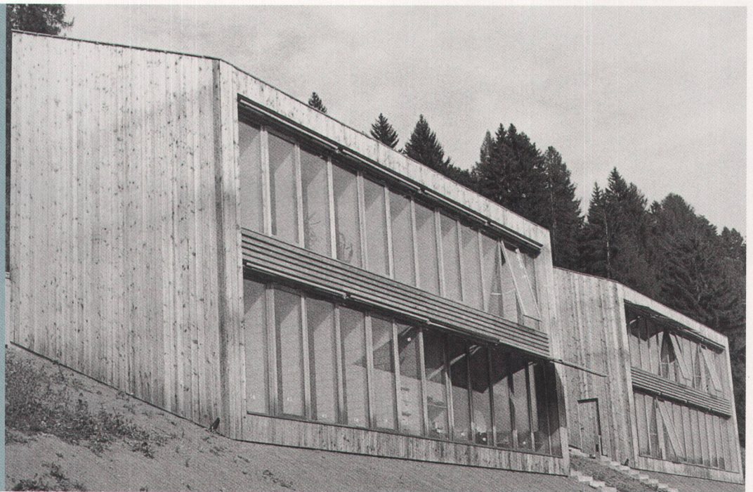
Die südgerichtete Fensterfront lässt die zum Heizen nötige Energie hindurch
