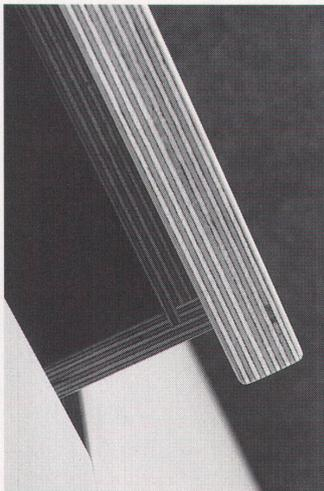
«Um edles Holz möglichst effizient einzusetzen brauchen wir bei uns das aus minderwertigen Materialien hergestellte Sperrholz und veredeln es mit Furnieren aus Ahorn.»
