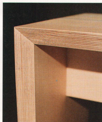
Die Kanten zeigen die verschiedenen Schichten des Birken-Multiplex
