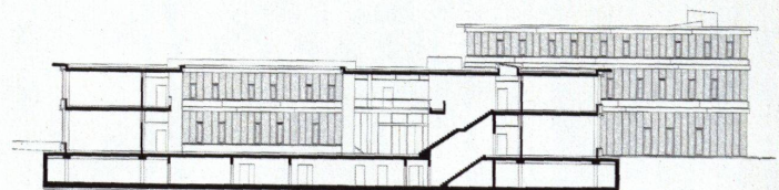
Schnitt durch das Unterrichtsgebäude mit dem Atrium
