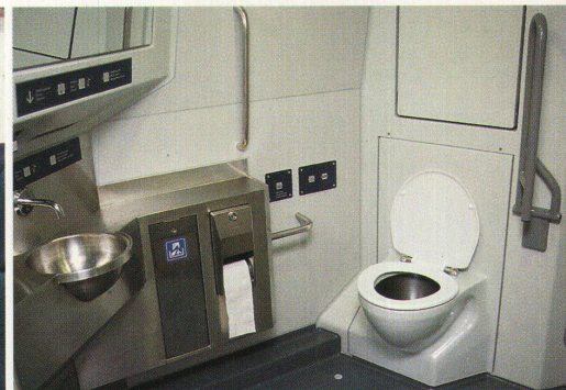
Endlich sind die Tastaturen in den Toiletten klarer angeordnet und durch bessere Grafiken und Beleuchtungen hervorgehoben
