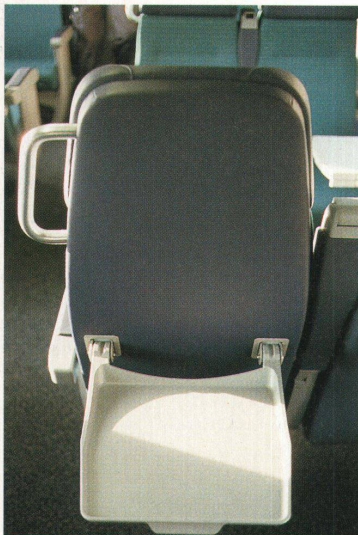
Mehr braucht ein guter Klappstisch im Zug nicht: Fläche, Rand und Stabilität. Das alles haben die Designer in einem einzigen Teil untergebracht. Und formschön ist es auch noch
