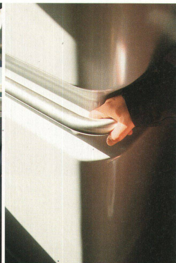
Der Handlauf aus Chromstahl ist mit dem Wissen entstanden, dass er Sicherheit geben muss – selbst dann noch, wenn der Zug durch die Kurven braust
