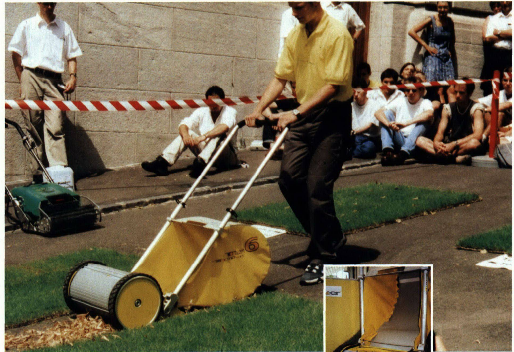
Die Messertrommel dieses Handrasenmähers lässt sich mit einer Bürste tauschen
