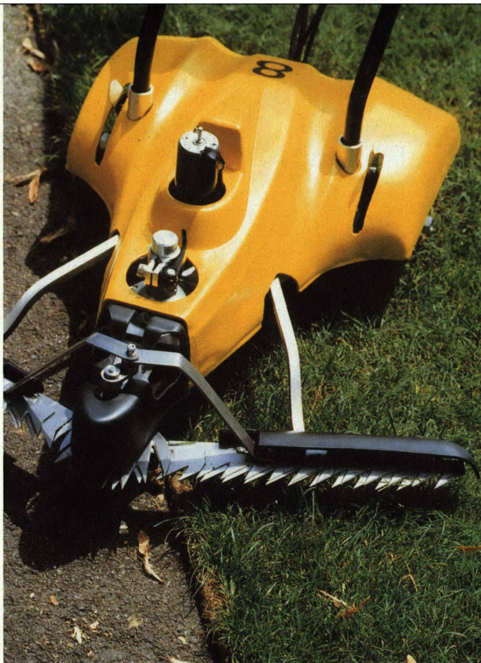
Die Schneideinheit des Wasserstrahlmähers. Zum Design der Verschaltung hats nicht mehr gereicht
