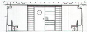
1-2 Schnitt durch die Buffet- und Treppeneinbauten, welche die beiden Decks des Motorschiffs «Zug» miteinander verbinden.
