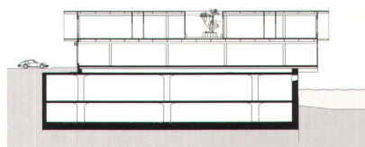
^ Der provisorische leichte Stahlbau steht auf zwei definitiven betonierten Untergeschossen.
