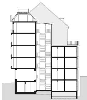
^ Das neue Treppenhaus verbindet das hohe Vorderhaus mit dem neuen Hinterhaus.
