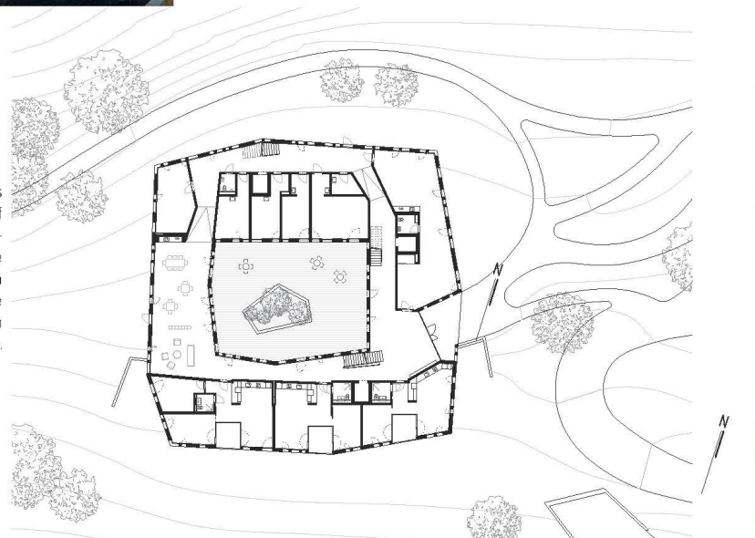
^Nach aussen und innen verglaste Loggien unterteilen die grosszügigen Wohnräume und bilden Klimapufferzonen.
