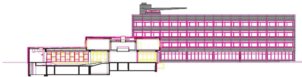
^Der Querschnitt durch den Spezialtrakt zeigt die Leitungsführung im ehemaligen Dacheinschnitt über dem Korridor.
