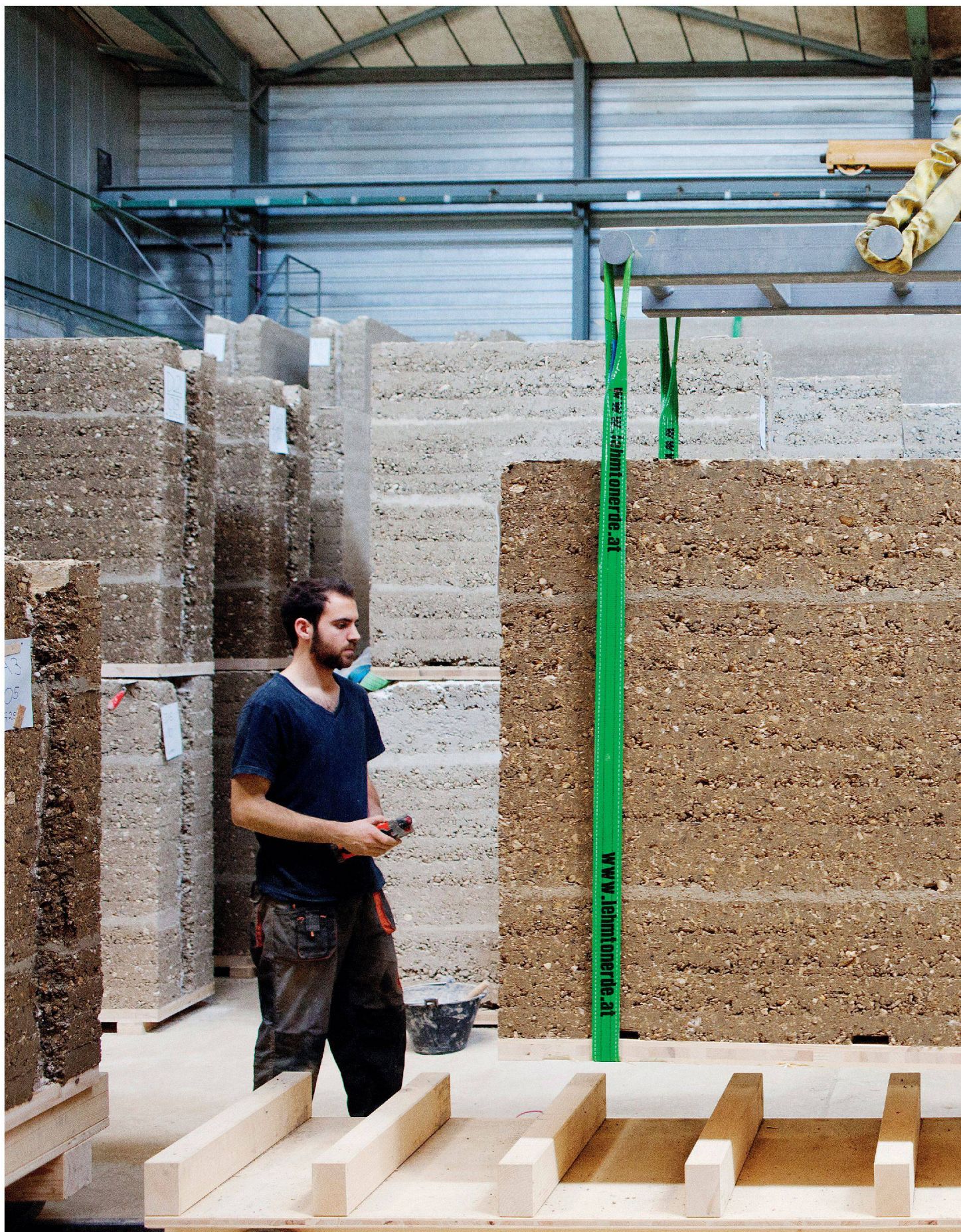
Der Hallenkran gab die Grösse vor: fünf Tonnen Stampflehm beim Transport.
