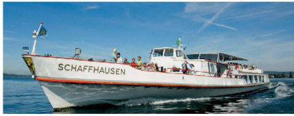
Die «MS Schaffhausen» mit neu sandgestrahltem Rumpf.
