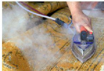
Mit Dampf werden der alte und neue Flor verbunden.
