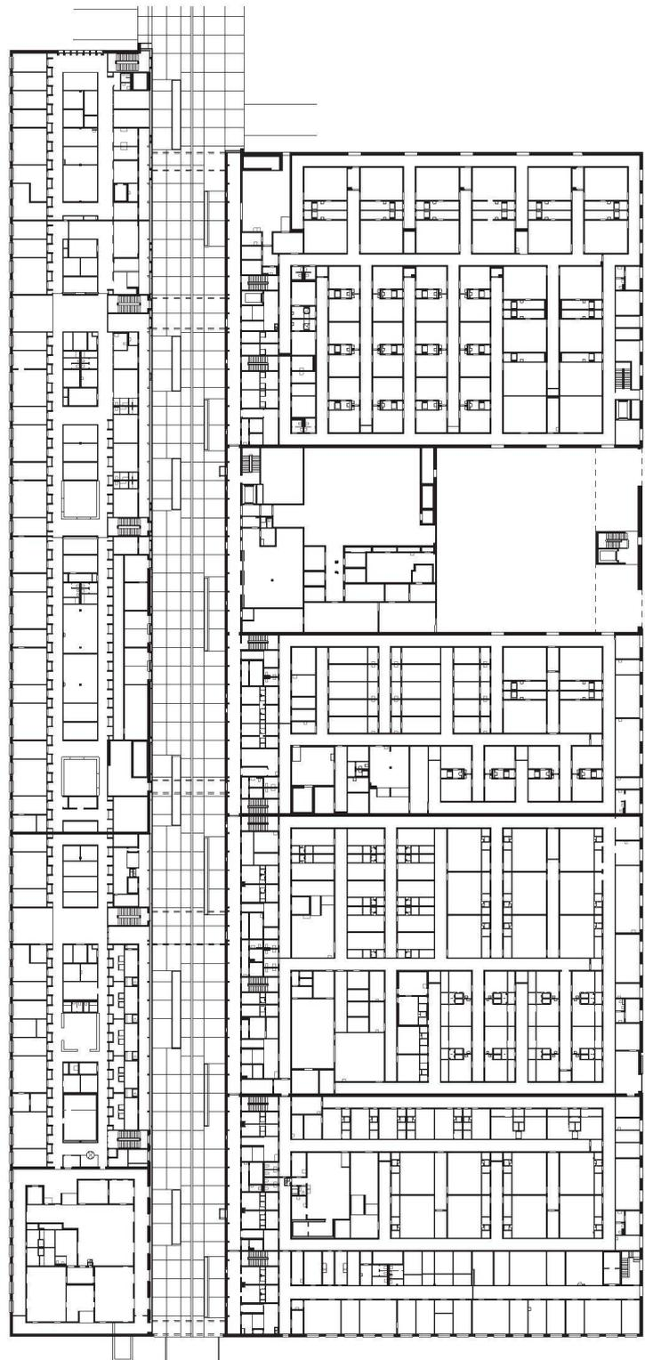
Grundriss Erdgeschoss: Der schmale Labortrakt wird durch eine offene Strasse vom Stallgebäude getrennt. Die Sicherheitsstufen steigen von West nach Ost an.
