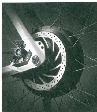
Der Hinterradnabenmotor unterstützt bis zu Tempo 45 km/h.
