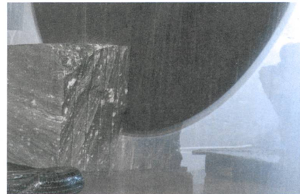
Mit der Fräse entstehen präzise geschnittene Riemen.
