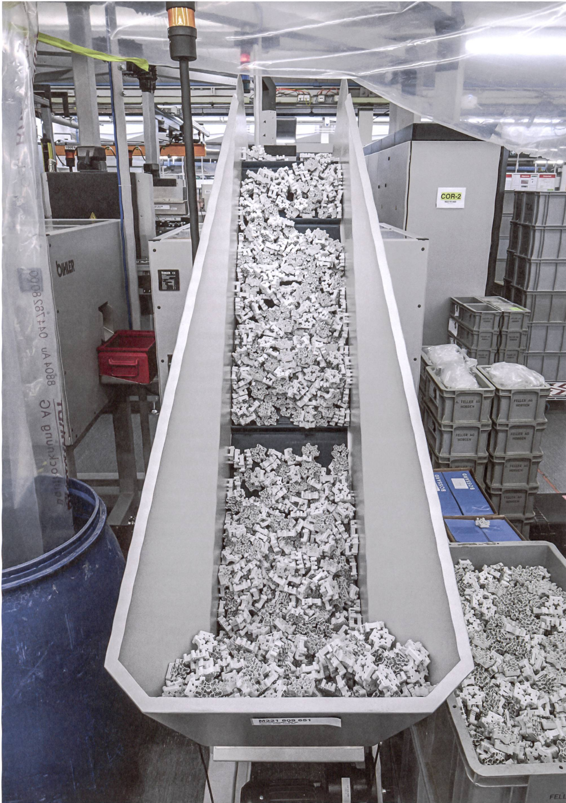
Diese Teile der Dreifachsteckdose sind später nicht mehr sichtbar – in die Kunststoffgehäuse werden die Klemmen gelegt.
