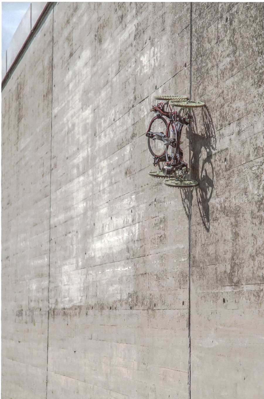
«Vertigo» geht die Wände hoch. Das gelingt dem Roboter dank zwei Rotoren auf seinem Rücken.
