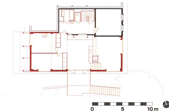
Wohngeschoss: Treppe und Nasszellen liegen im alten Wohnteil des Hauses. Sie spielen die Räume in der ehemaligen Scheune frei.
